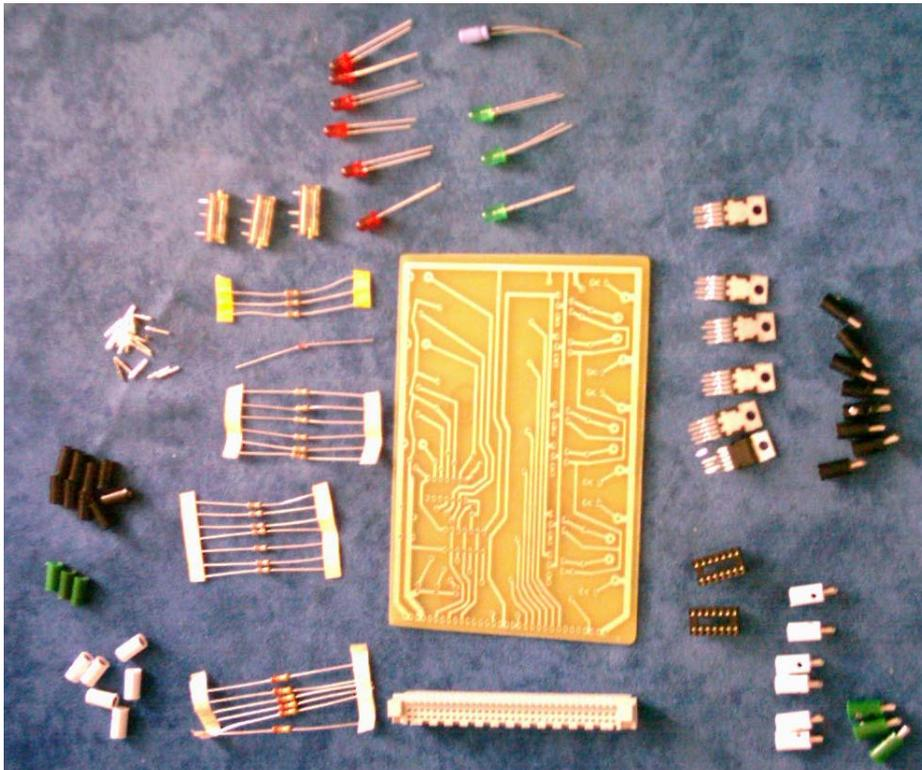
Abb. 5.5-9 vorgefertigte Platine mit den dazugehörigen Bauteilen
